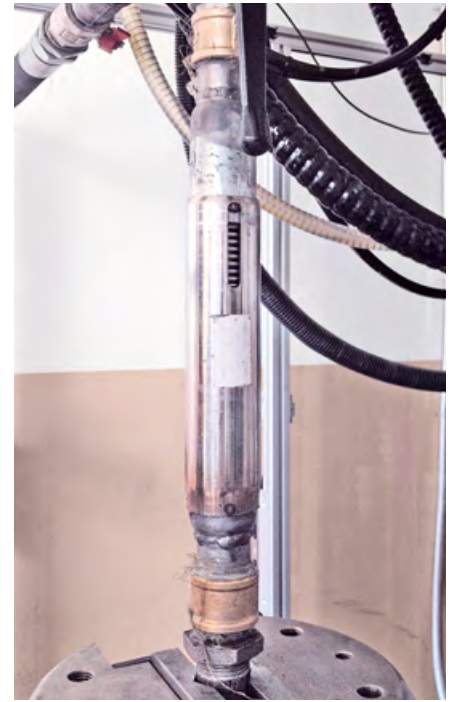
Испытание компенсаторов в машине Instron 8850 на подтверждение вероятности безотказной работы (ВБР)
