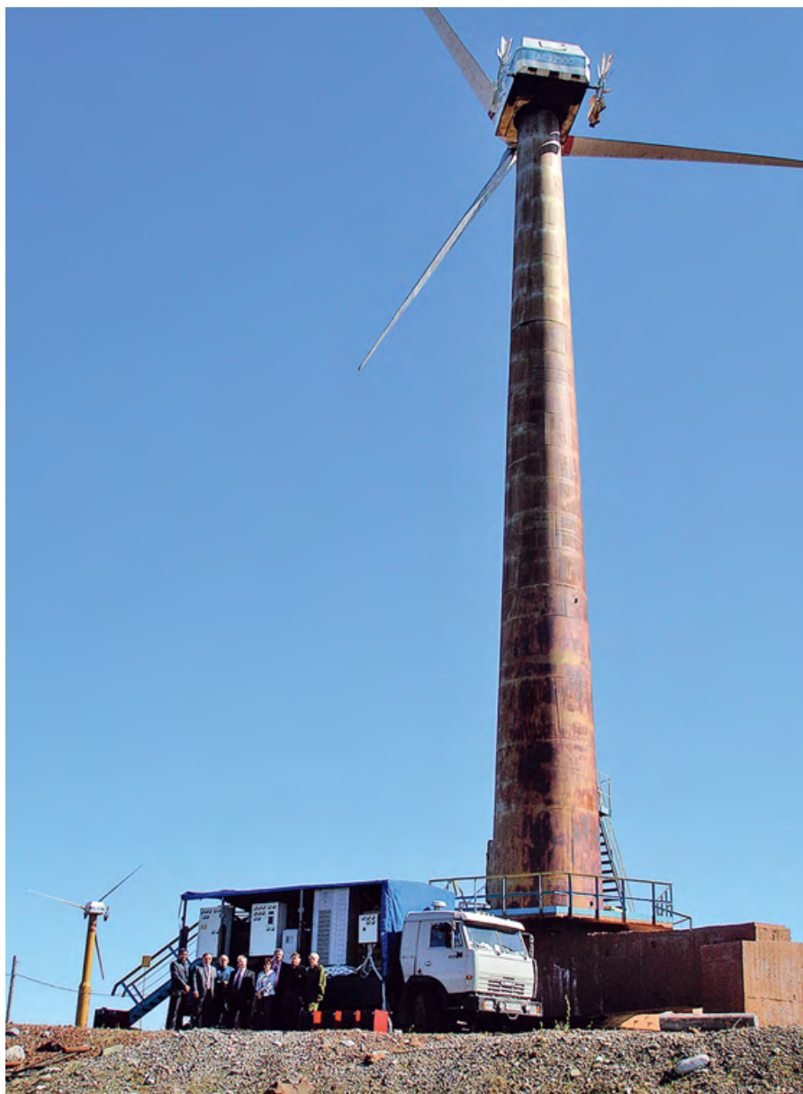
❖ Фото 1. Испытания основных блоков МЭК в городе Воркута, 2008-й год (испытана работоспособность основных блоков МЭК: ВЭУ; ДЭС с ДВС, позволяющим работать на частичных оборотах, и все-режимным генератором; преобразователя частоты; системы управления)
