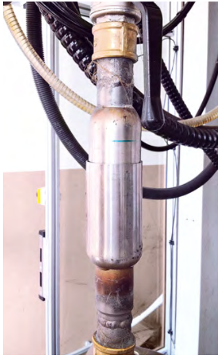
Испытание компенсаторов в машине Instron 8850 на подтверждение вероятности безотказной работы (ВБР)
