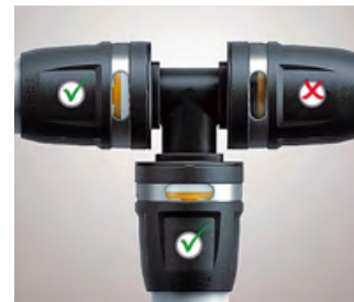
⌘ г) при правильном монтаже трубу видно в смотровое окошко
