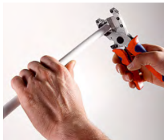
⌘ а) обрезаем трубу при помощи труборезных ножниц
