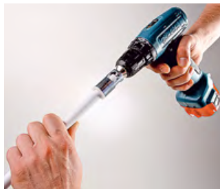
⌘ б) калибруем трубу, а затем снимаем фаску
