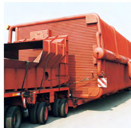
❖ Водотрубный водогрейный котел мощностью 100 МВт при транспортировке
