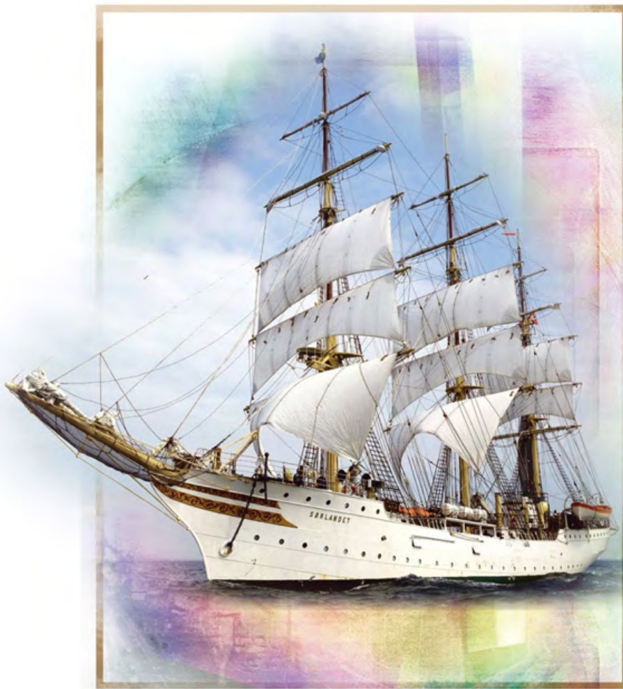
Sørlandet — учебный парусник Норвегии. Готовит офицеров Морского Флота. В 1933 году представляла Норвегию на выставке в Чикаго. В 1986 году Sørlandet участвовала в праздновании 100-летия статуи Свободы в Нью-Йорке. Водоизмещение — 891 т, высота мачт — 35 м, длина габаритная (с бушпритом) — 65 м, экипаж — 15 чел., площадь парусов — 1166 м 2 . Построен в 1927 году.
