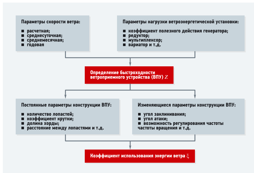
⦿ Рис. 1. Схематичный алгоритм разработки ветроприемных устройств
