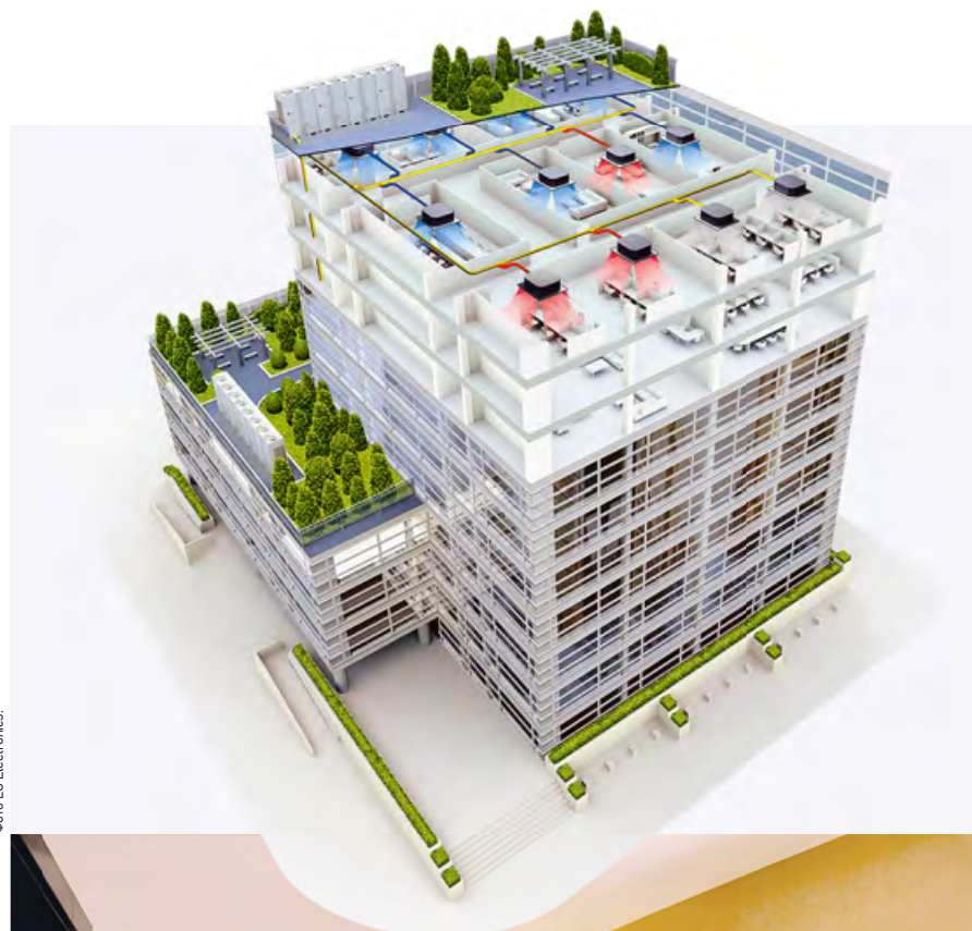
■ Рис. 1. Использование VRF-системы Multi V III с рекуперацией теплоты
