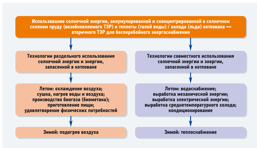
Рис. 1. Составные элементы солнечной энергетики на базе солнечного соляного пруда, предлагаемой для средней полосы России
