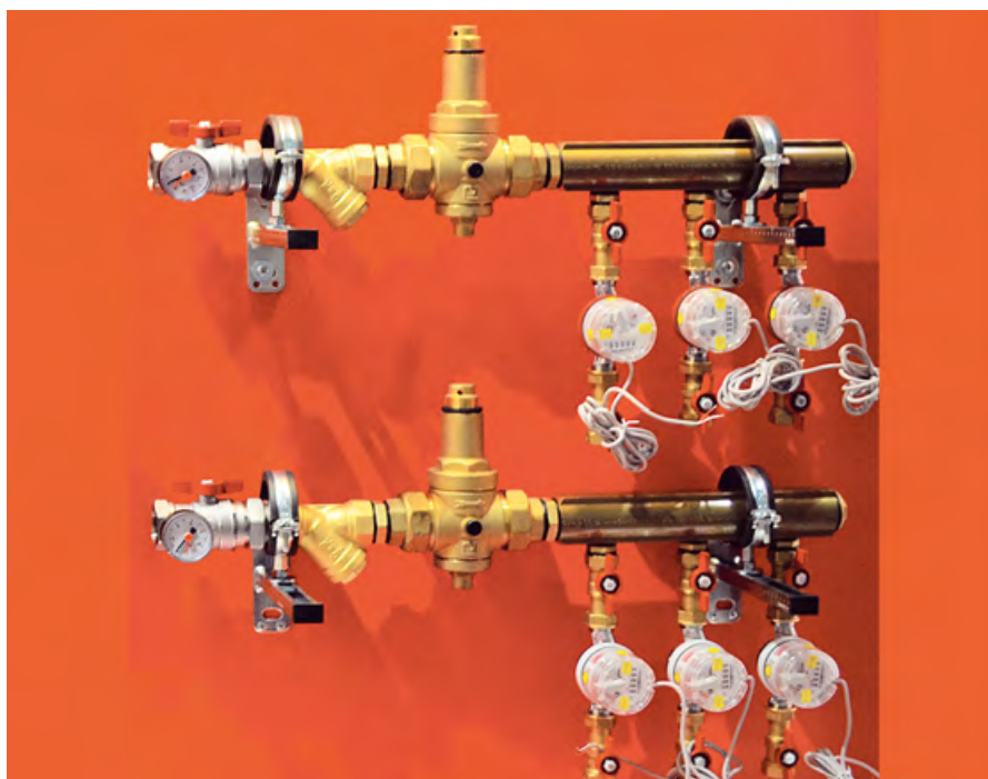
❖ Коллекторный узел GE550Y19x является индивидуальным квартирным коллектором со встроенными отсечными балансировочными клапанами для подключения отопительных приборов при лучевой или периметральной разводке и индивидуальным теплоучетом
