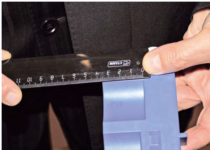
❖ Фото 3. Необходимая глубина вставки трубы в фитинг перед обжатием — 35 мм
