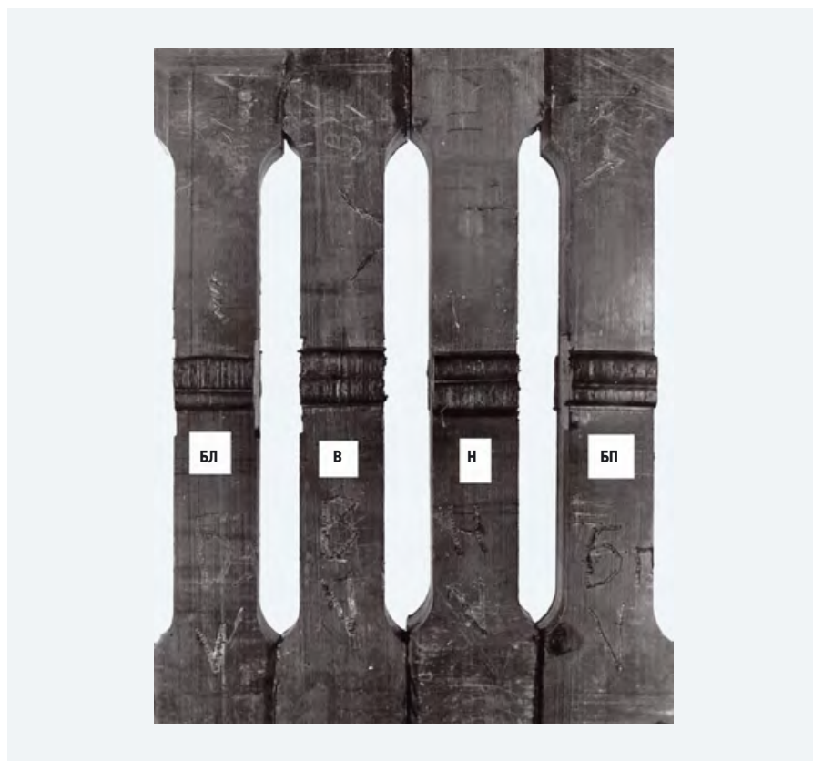
:: Рис. 3а. Образцы сварных соединений с галтелями для испытаний на одноосное растяжение
