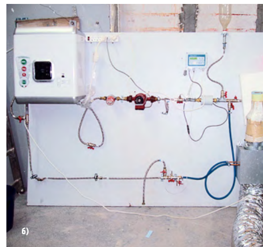
Рис. 11. Принципиальная схема макета (а) и фотография (б) установки с подогревом воздуха от системы теплоснабжения [1 — накопительный водонагреватель; 2 — водяной calorifer; 3 — клапан регулирующий трехходовой с электроприводом; 4 — циркуляционный насос; 5 — прибор учета расхода воды; 6 — теплосчетчик; 7 — кран шаровой; 8 — заливная горловина; 9 — щит (стенд); 10 — слив (кран шаровой)]
