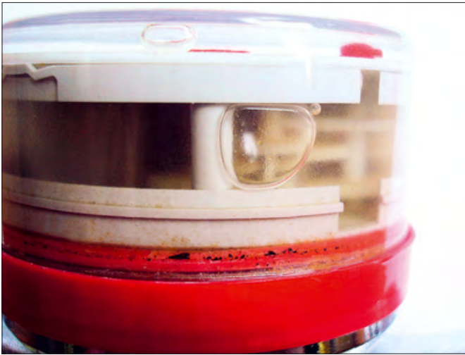
Фото 1. Попадание воды в счетный механизм водосчетчика из-за выдавливания прокладки
