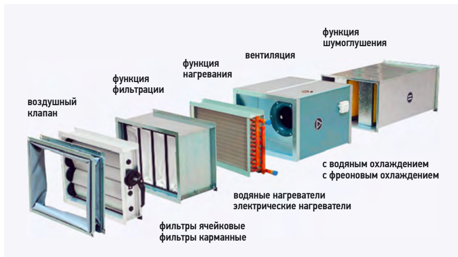
❖ Рис. 2. Новые вентагрегаты Ventus N-Туре состоят из отдельных функциональных секций
