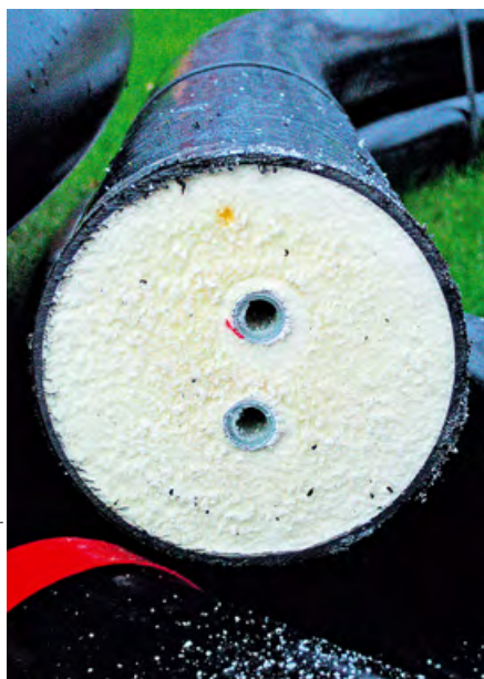
❖ Фото 2. Энергосберегающая труба с диффузионным барьером (наружный диаметр трубы с теплоизоляцией 110 мм, внутренний диаметр трубы для жидкости — 10 мм)
