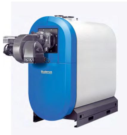
с низкоэмиссионной горелкой Logano plus SB745 значительно снижает количество вредных выбросов в атмосферу. Специальные звукопоглощающие каналы прохода отопительных газов существенно снижают уровень шума работы котла.
