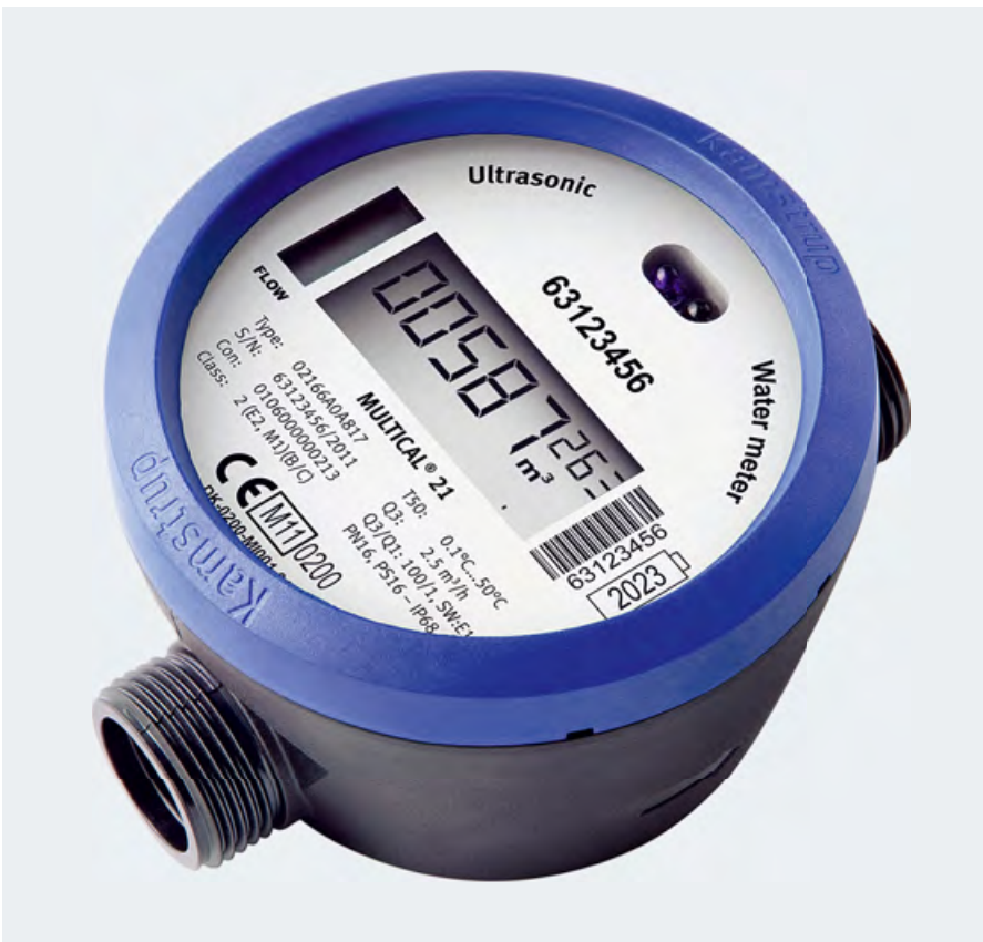
● Последняя модель электронного водосчетчика на рынке — Multical 21 — похож на обычный водосчетчик, но имеет микропроцессорный вычислитель и ультразвуковой датчик расхода в едином герметичном корпусе. Корпус счетчика изготовлен из композитного материала (PPS), защищающего важные органы счетчика от контакта с водой
