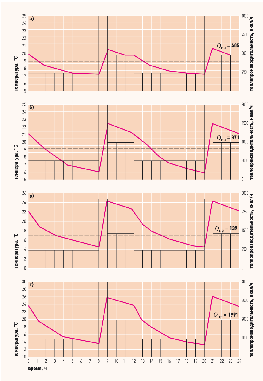
Рис. 5. Изменение температуры воздуха в помещении от суточной теплотдачи для коэффициентов теплопередачи [а — 0,2; б — 0,4; в — 0,6 и г — 0,8 ккал/(ч·м 2 ·°C)]
