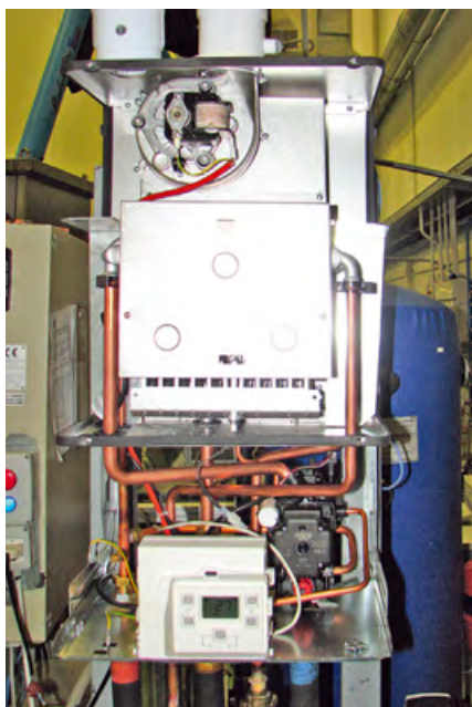
❖ Котел на испытательном стенде в лаборатории компании Biasi S.p.A.
