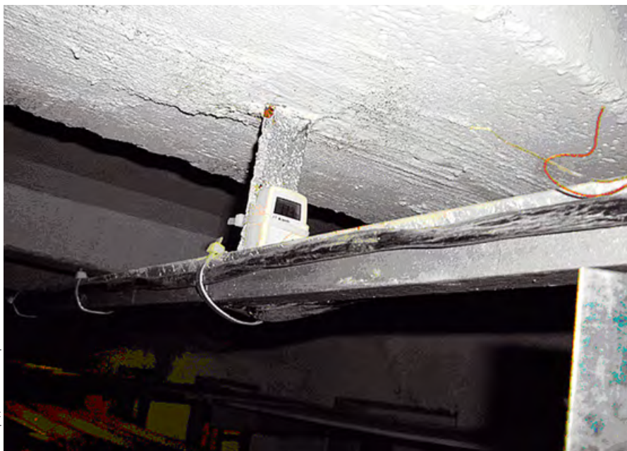
•• Фото 1. Пример размещения одного из регистраторов в верхней зоне сечения канала
