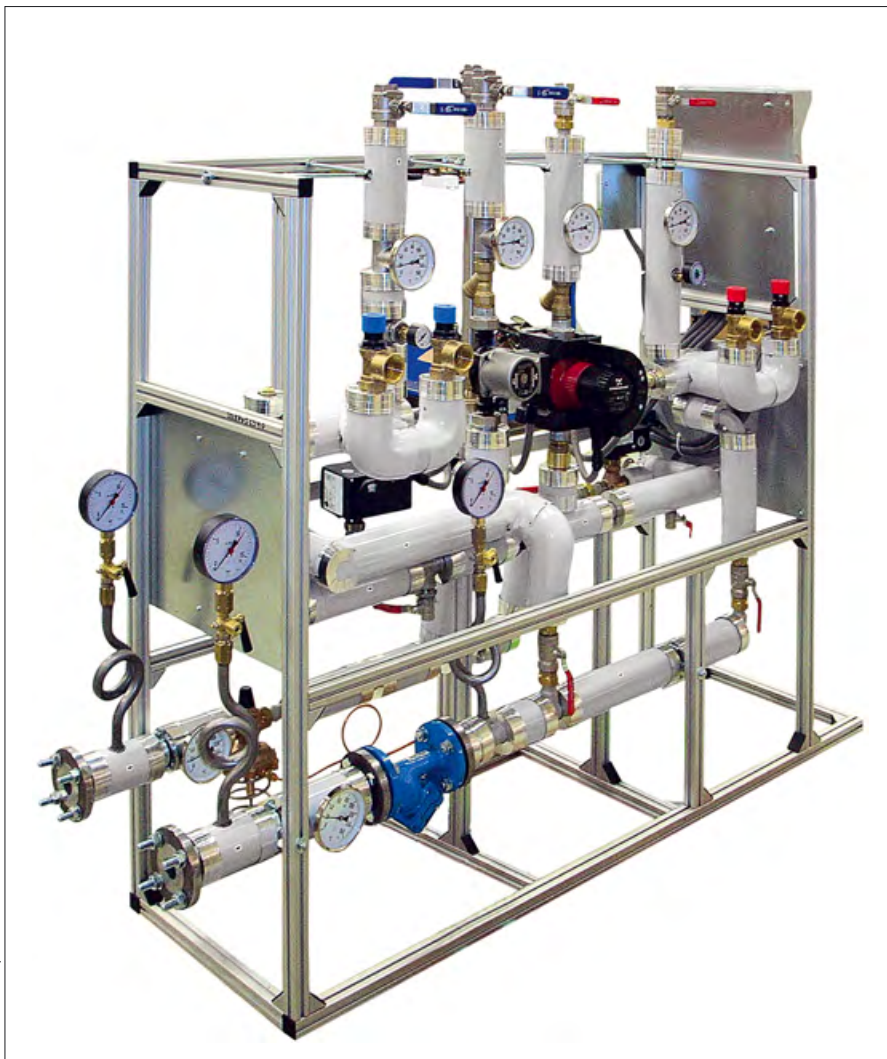
❖ Тепловой пункт для системы теплоснабжения и приготовления ГВС
