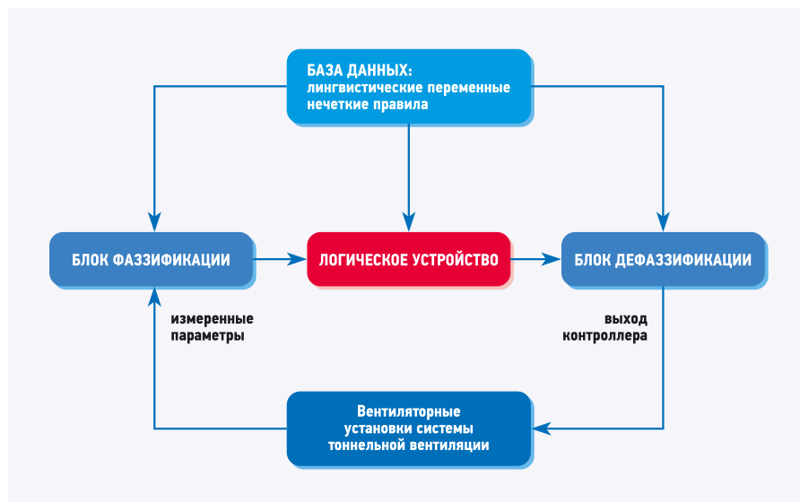
Рис. 5. Блок-схема нечеткого микроконтроллера
