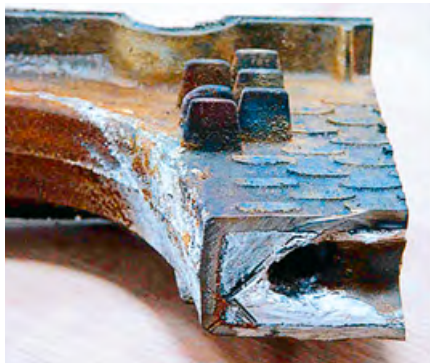
Рис. 1. Секции теплообменника в разрезе: результат отложения солей жесткости
