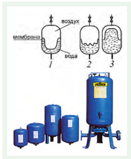
■ Рис. 5. Конструкция расширительного бака (1 — положение мембраны перед установкой: предварительная накачка воздухом на 0,1–0,3 бар; 2 — положение мембраны после подключения бака к сети; 3 — положение мембраны при температурном расширении жидкости)
