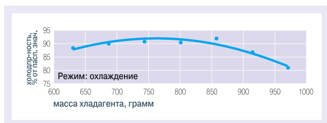
Рис. 1. Зависимость холодопроизводительности кондиционера от объема заправки хладагентом
