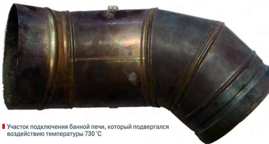
■ Участок подключения банной печи, который подвергался воздействию температуры 730°C
