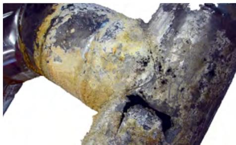
Рис. 4. Участок подключения котла на дизельном топливе, выполненный из серии ферритных сталей AISI 400
