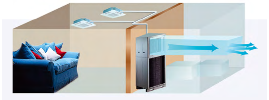
■ Возможность подключения к наружному блоку системы Multi V Space II воздуховодов позволяет размещать его в любых помещениях здания
