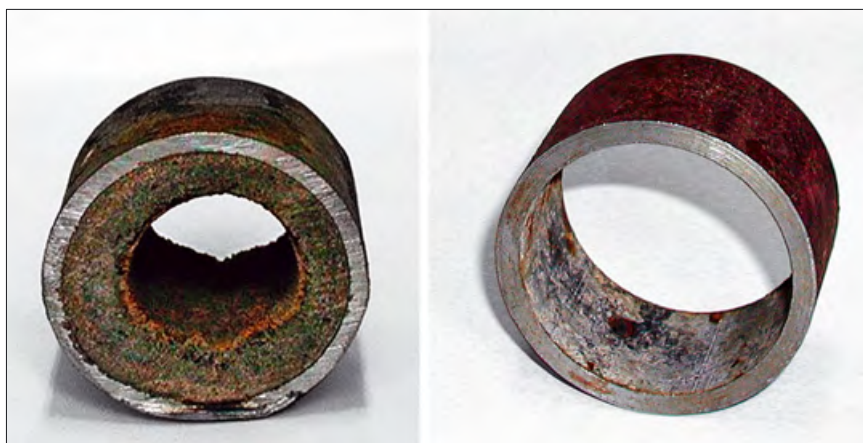
■ Рис. 1. Фрагменты трубы до (а) и после (б) обработки методом термодинамической активации воды средством СОТ-2000
