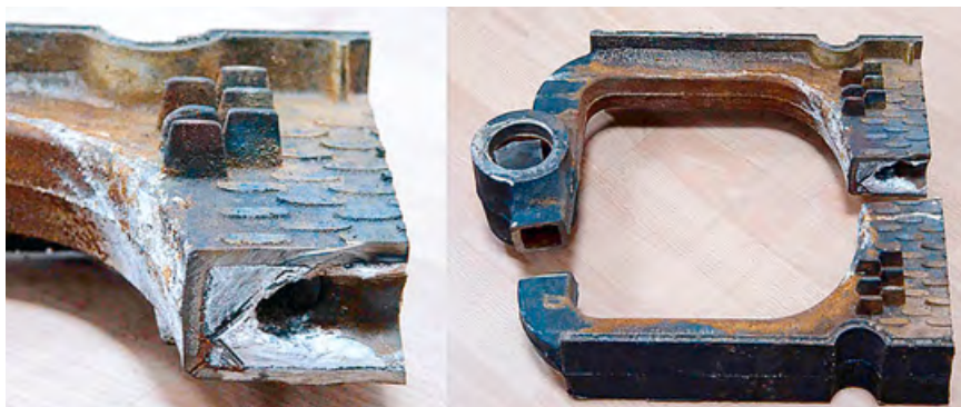
■ Фото 1. Секции теплообменника в разрезе: результат отложения солей жесткости
