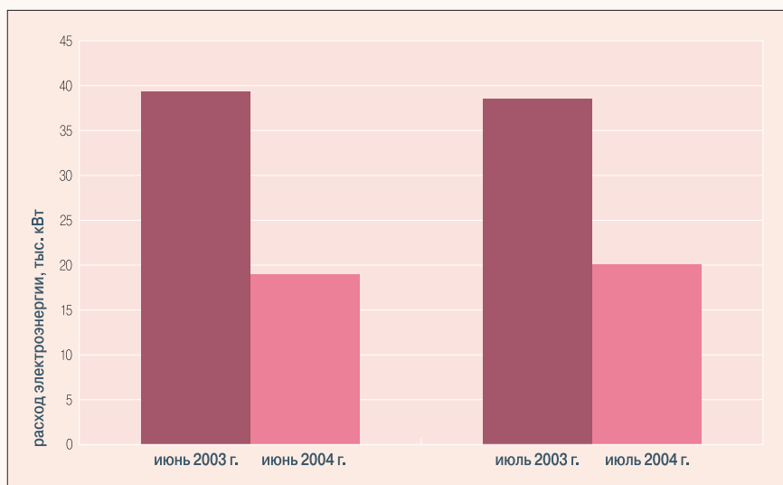
■ Рис. 2. Энергопотребление на НС-71 (г. Тольятти) до/после установки насосов Grundfos серии CR
