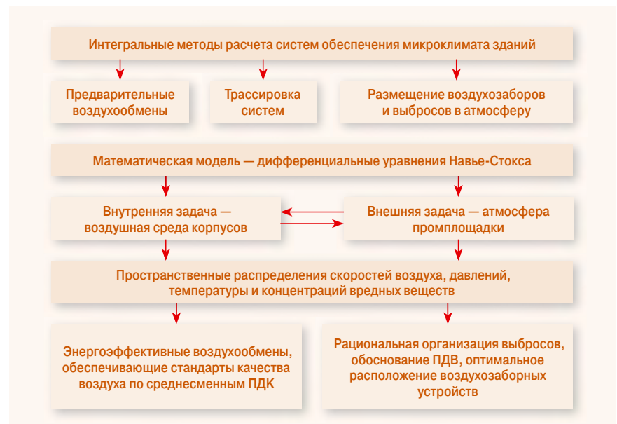
■ Рис. 1. Схема метода для расчета систем вентиляции зданий
