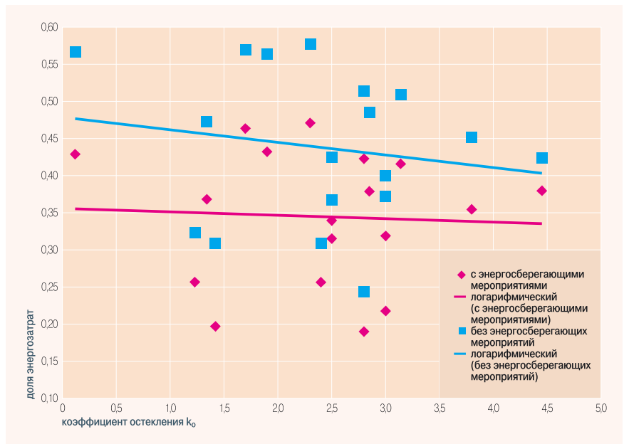
Рис. 2. Корреляционная зависимость величины доли трансмиссионных теплотерь от коэффициента остекления k_o
