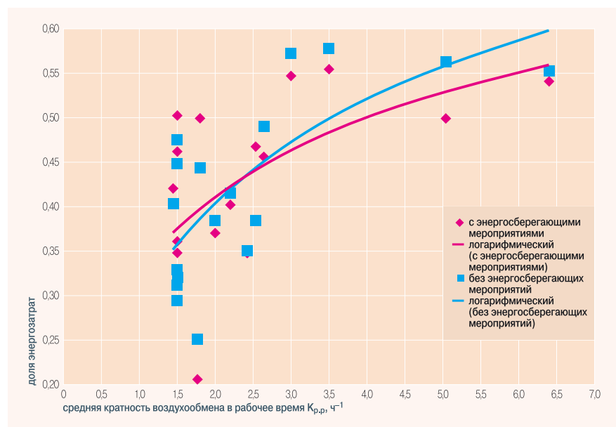
■ Рис. 1. Корреляционная зависимость доли энергозатрат на подогрев воздуха от кратности воздухообмена в рабочее время K_{р,р}
