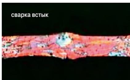
■ Рис. 5. Аллюминиевый слой трубы MultiPex, сваренный встык
