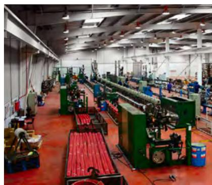
■ Рис. 2. Технологические линии по производству МПТ
