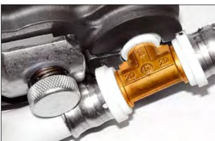
4. Установить фитинг кольцевым зазором на трубу и дослат до упора. Правильность расположения трубы на фитинге контролируется по отверстиям в пресс-гильзе.
