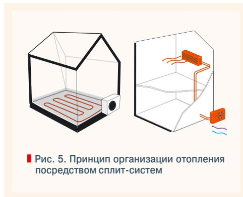
■ Рис. 5. Принцип организации отопления посредством сплит-систем
