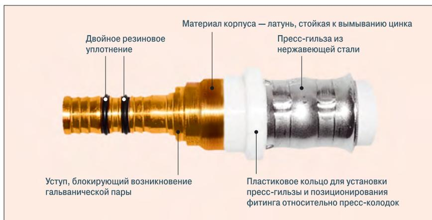
Пресс-фитинги HERZ предназначены для сантехнических и отопительных приборов. Пресс-гильзы выполнены из легированной нержавеющей стали и вместе с запатентованной системой из двух уплотнительных колец EPDM обеспечивают 100% герметичность соединения.
