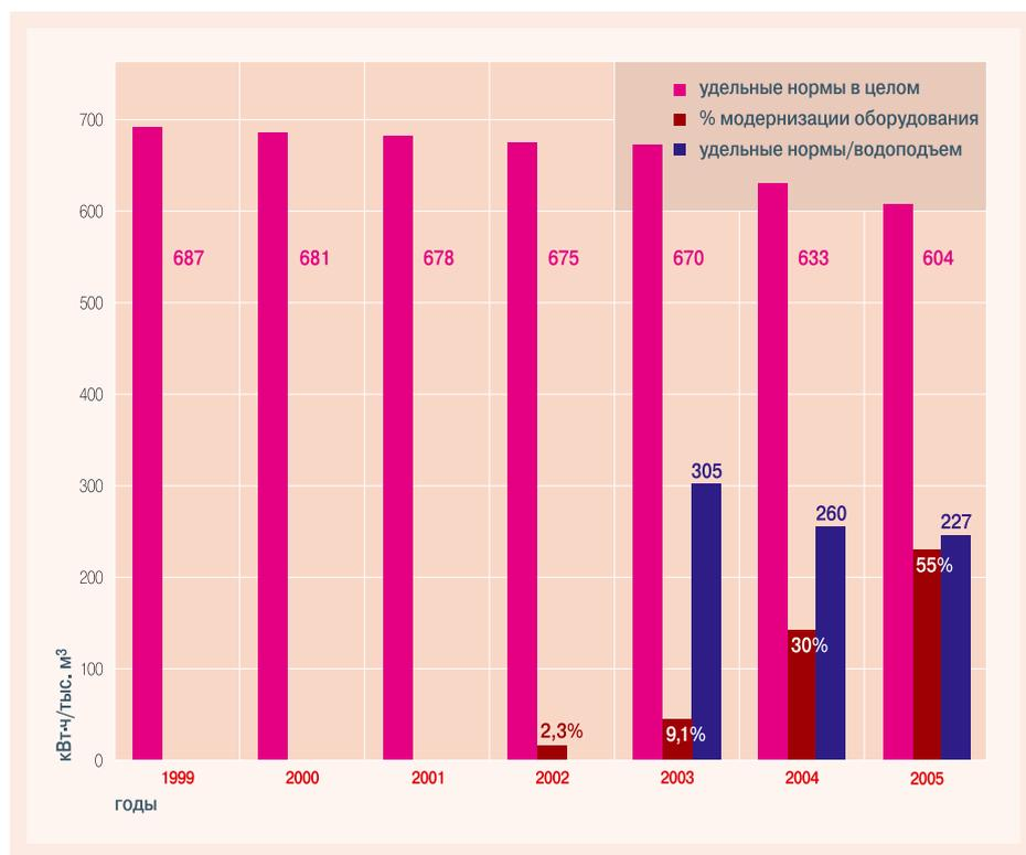
Рис. 1. Динамика изменения удельной нормы энергопотребления за счет модернизации оборудования
