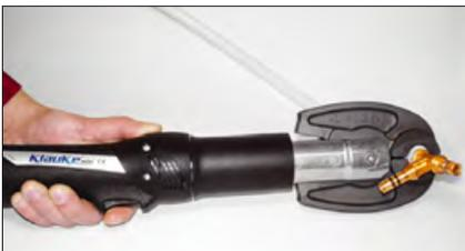
3. С помощью инструмента «Клауке» для опрессовки необходимо опрессовать фитинг подготовленного соединения. При этом труба должна быть свободна от напряжений. Выступ пластикового кольца должен располагаться в канавке пресс-колодки и по окончании опрессовки должно быть достигнуто полное закрытие прессовых колодок.
