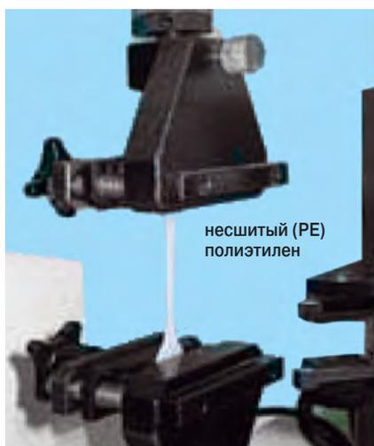
■ Рис. 4. Испытание на разрыв металлопластиковых труб
