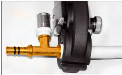
5. Для монтажа системы HERZ Pipe fix используются прессовые аппараты «Клауке» (ручные, электрические и др.) с пресс-колодками имеющими профиль «ТН». После опрессовки на поверхности пресс-гильзы фитинга остаются две уплотнительные канавки — следы от инструмента. При правильной опрессовке эти следы должны быть равномерными и сплошными по всей окружности.
