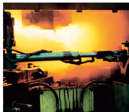
■ Рис. 3. Горячая штамповка фитингов для МПТ на автоматизированных линиях завода
