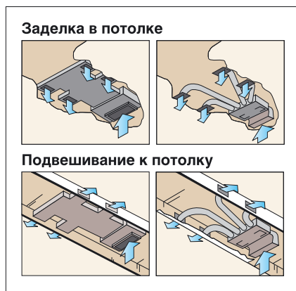
■ Рис. 4. Особенности подачи воздуха в обслуживаемые помещения канальными моделями
