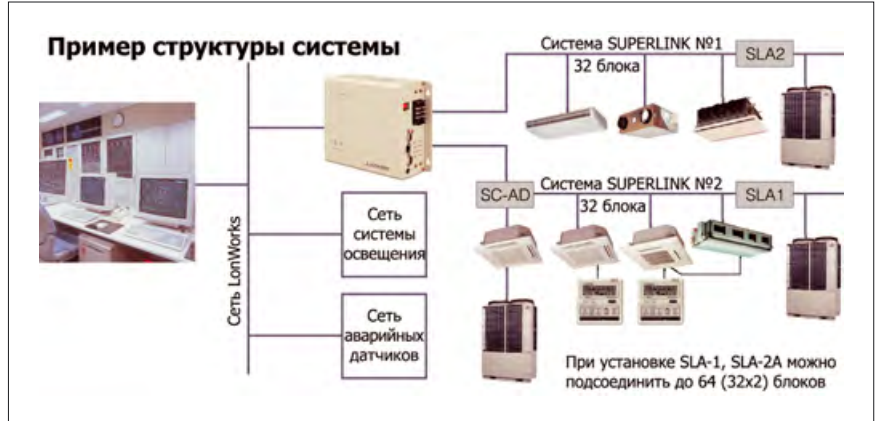
■ Рис. 6. Структура системы управления. Два порта подключения для SuperLink
