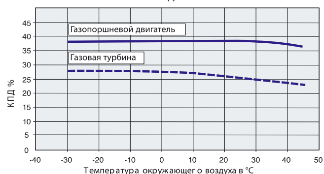
■ Графики зависимости — КПД газопоршневого двигателя от нагрузки; КПД газовой турбины от нагрузки; электрического КПД от температуры воздуха
