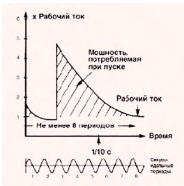
■ Рис. 2. Пуск электродвигателя по методу «звезда-треугольник»
