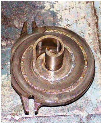
■ Спираль компрессора со следами гидроудара
