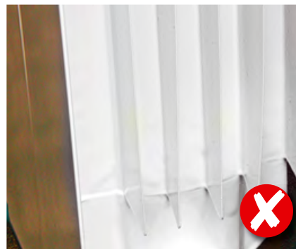
■ Геометрические размеры не отличаются точностью, а конструкция – травмобезопасностью
