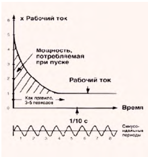
■ Рис. 1. Электрические характеристики прямого включения погружных электродвигателей методом DOL
