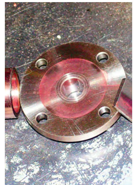
■ Омеднение механических частей ротационного компрессора
