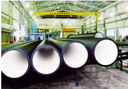
■ Производство двухслойной профилированной трубы «Корсис» на Климовском трубном заводе
