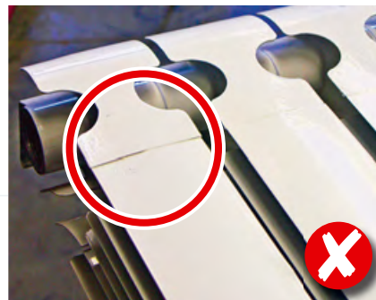
■ Подделки выполнены методом экструзии, причем «выдавлены» через форму по частям, которые склеены между собой
