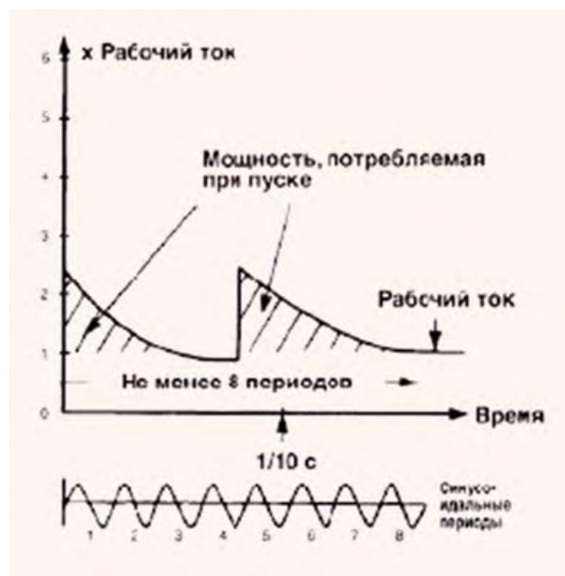
■ Рис. 3. Пуск электродвигателя через пусковой трансформатор
