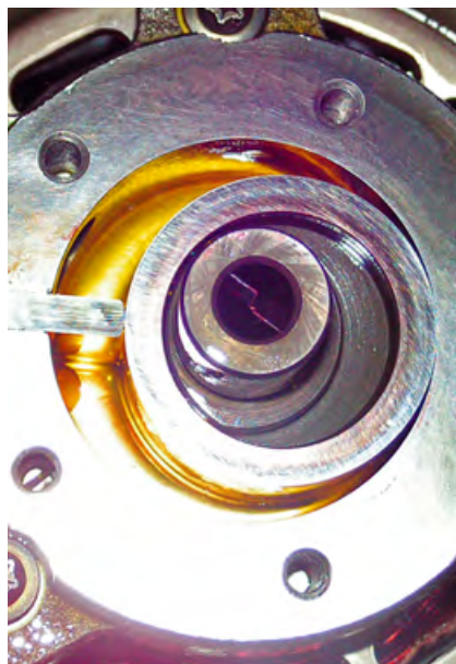
■ Механические части ротационного компрессора
