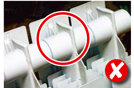
■ В выполненных экструзией подделках эти элементы носят чисто декоративную функцию
