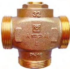
Термосмесительный клапан «Тепломикс» для повышения температуры в обратном потоке — это автоматически регулируемый термосмесительный трехходовой клапан. Клапан оснащен термостатическим устройством, предназначен для повышения температуры обратной линии в теплоцентралях до 50 кВт и для защиты котельного оборудования от коррозии. Подмес через байпас между подающей и обратной линии происходит таким образом, что температура
