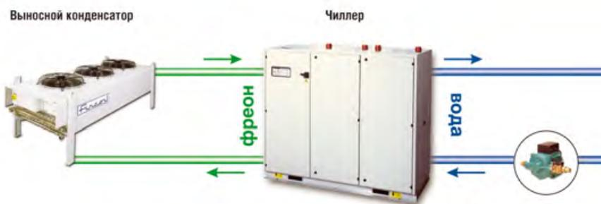
Рис. 4. Бесконденсаторный чиллер с выносным конденсатором
