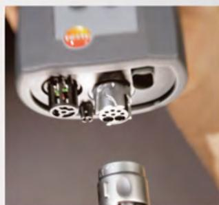
Один разъем для быстрого подсоединения зонда
