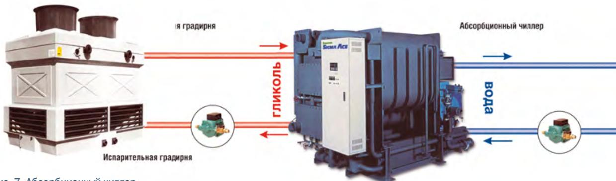
Рис. 7. Абсорбционный чиллер
