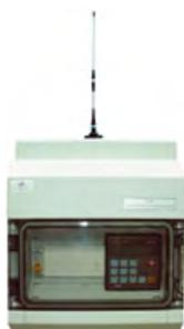
В отличие от подобных устройств система U-90 способна передавать не только аварийные сигналы с дискретных датчиков (контакт замкнуто-разомкнуто), но и сигналы от аналоговых датчиков (величина температуры, давления, влажности и пр.). Особенности системы U-90:
