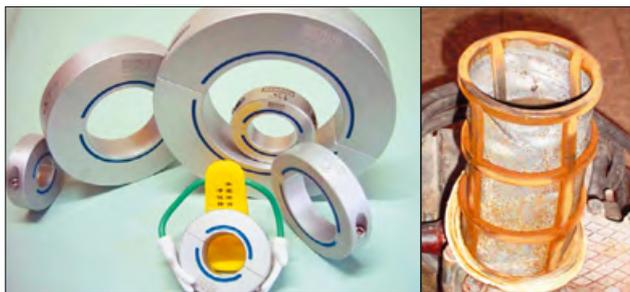
■ 13. Внешний вид приборов Merus и состояние сетчатого фильтра, через месяц после установки прибора
