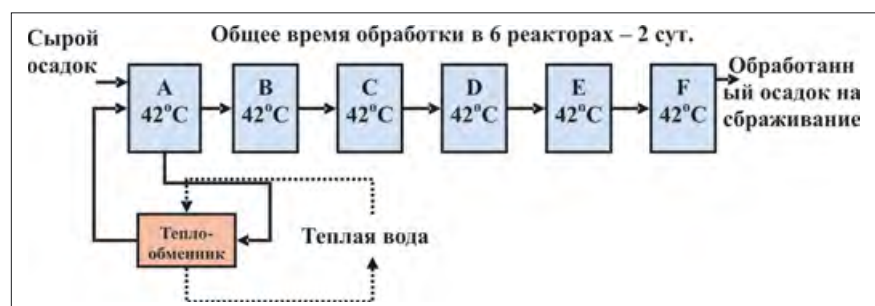
■ Рис. 2. Схема системы гидролиза компании «Монсал» — Тип ЕН
