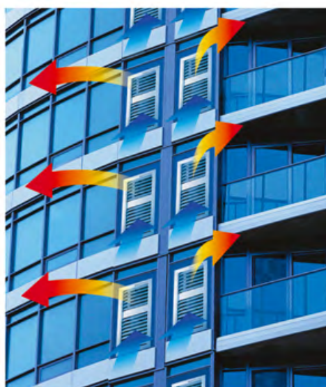
Рис.2. Потоки горячего воздуха от блоков систем кондиционирования, расположенных друг над другом.
