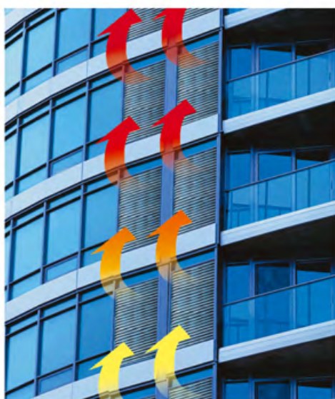
Рис.2. Потоки горячего воздуха от блоков систем кондиционирования, расположенных друг над другом.
