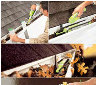
Looj можно использовать и как ручной инструмент. Приятно, что робота можно мыть под струей воды (фото — iRobot, gizmag.com)
