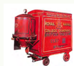
Пылесос, изготовленный в 1902 г. британцем Хубертом Сесилом Буттом. Такие пылесосы ездили по улицам Лондона, шланг просовывался прямо в окна домов.
