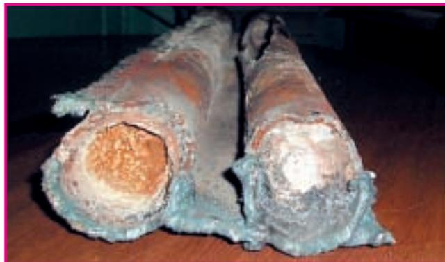
Рис. 6. Поперечное сечение экранных труб котла полностью забито отложениями накипи
