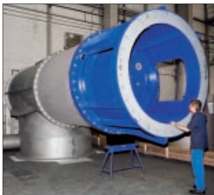
Напорное колено самых больших насосов для подачи охлаждающей воды для электростанции в городе Юхуань в Китае.
