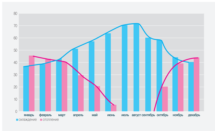
Рис. 8. Холодильные и тепловые нагрузки здания в Японии в долях от расчетной часовой (Kasai T., Kurachi M., Sumida Y. Разработка мультизональной СКВ с утилизацией тепла на фреоне R407C. АВОК, №5/1999).
