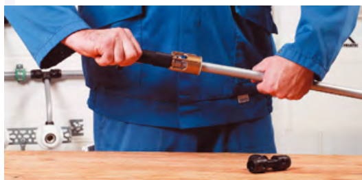
■ Рис. 2. 1-й этап: отрезать необходимый участок трубы
