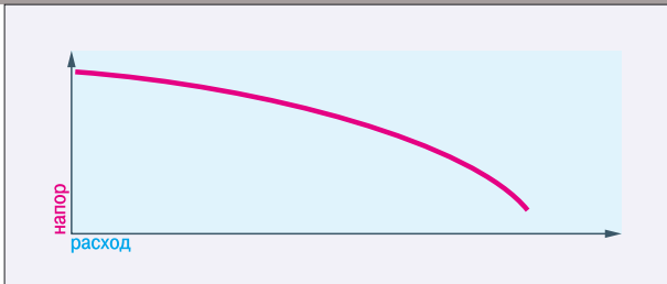
■ Рис. 6. Гидравлическая кривая центробежного насоса
