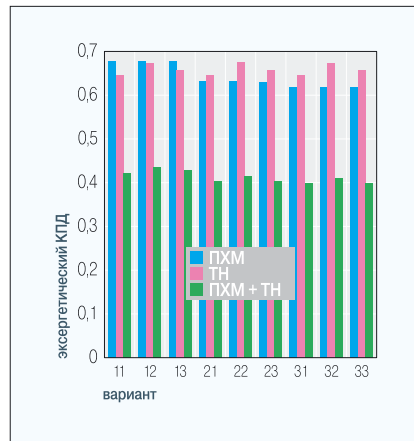
Рис. 5. Сравнение эксергетического КПД для ПХМ, ТН и СТХС. Номера вариантов соответствуют табл. 4
