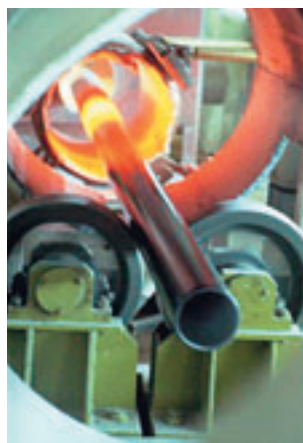
Обжиг трубы в проходном индукторе
