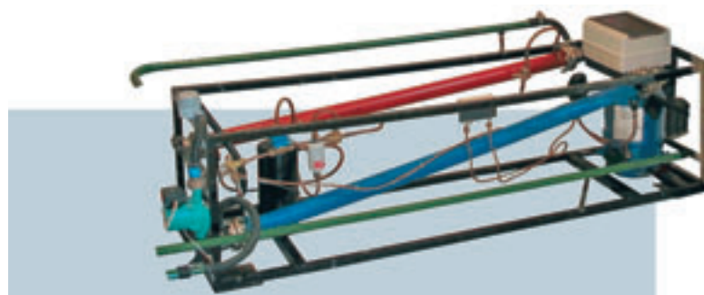
Тепловой насос тепловой мощностью 10 кВт, установленный в УМП «Водоканал», г. Малоярославец
