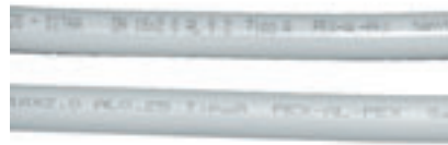
Рис. 2. Оригинальная металлопластиковая труба GENERAL FITTINGS сверху, подделка снизу
