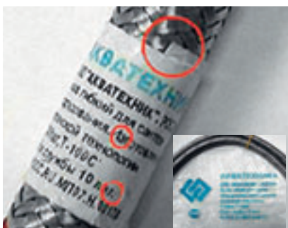
Рис. 1. Поддельная сантехническая подводка
