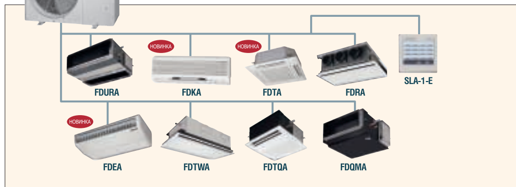
■ Рис. 1. Принципиальная схема двухтрубных VRF-систем
