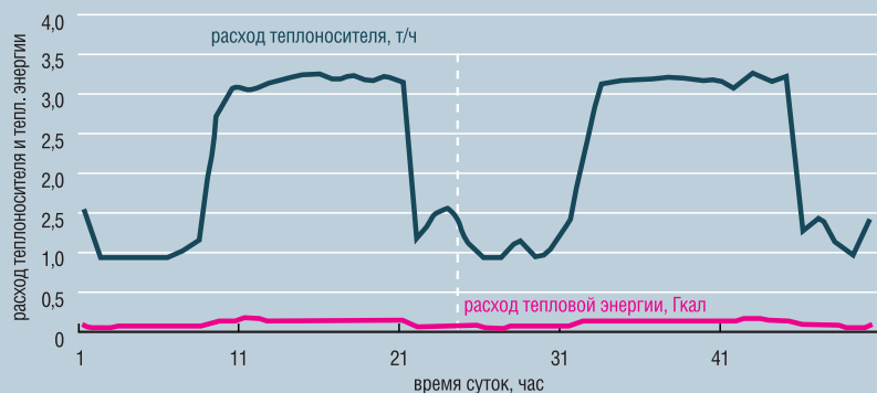
Рис. 3. Зависимость расхода теплоносителя и тепловой энергии от времени суток при работе системы отопления с регулятором «НОРМА»
