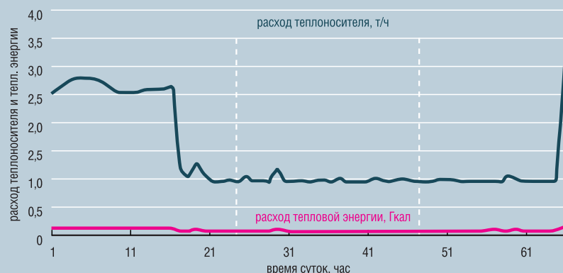
Рис. 6. Зависимость расхода теплоносителя и тепловой энергии от времени суток при работе регулятора «НОРМА» в режиме «выходной день»
