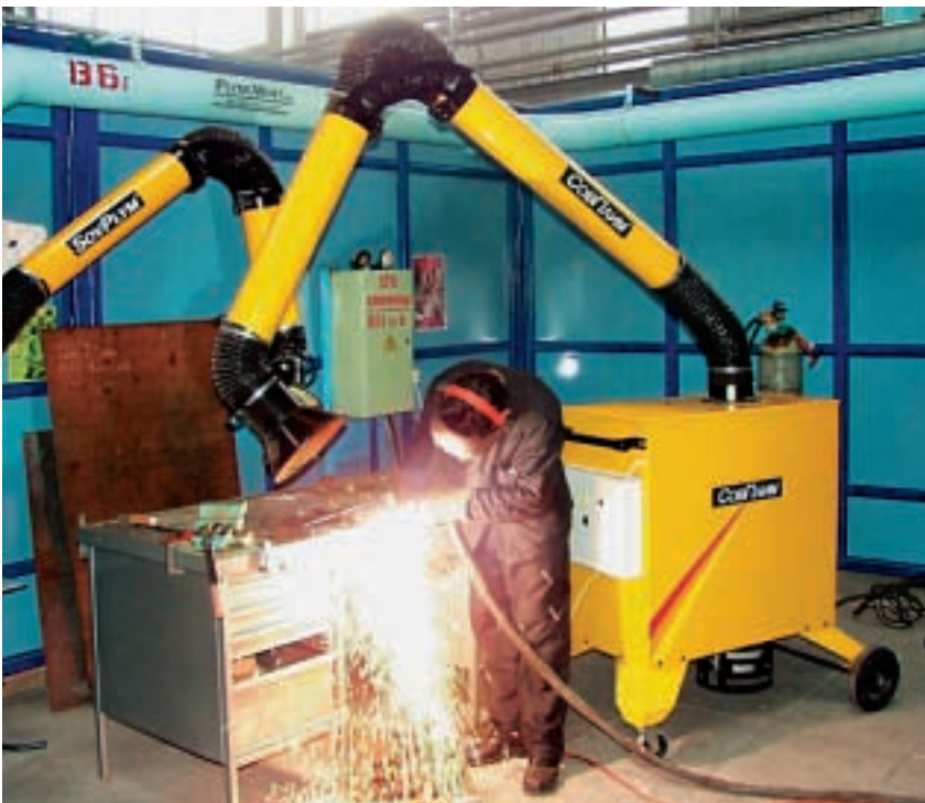
Мобильный фильтрующий агрегат ЕМК с электростатическим фильтром обеспечивает рециркуляцию воздуха.
