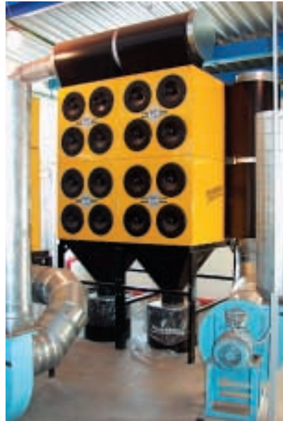
Кассетный самоочищающийся фильтр MDB имеет модульную конструкцию и собирается в зависимости от объема воздуха от 1000 м 3 до 32 тыс. м 3 . Фильтрующие кассеты применяются в зависимости от типа загрязнений.
