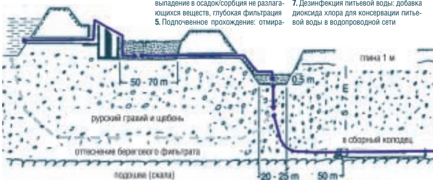
Процесс получения питьевой воды при помощи обогащения вод в долине р. Рур
