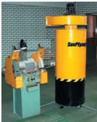
Пылеулавливающий агрегат ПУ предназначен для очистки загрязненного воздуха от средне- и крупнодисперсных частиц различных видов сухой пыли. Производительность агрегатов — до 4000 м 3 /ч.
