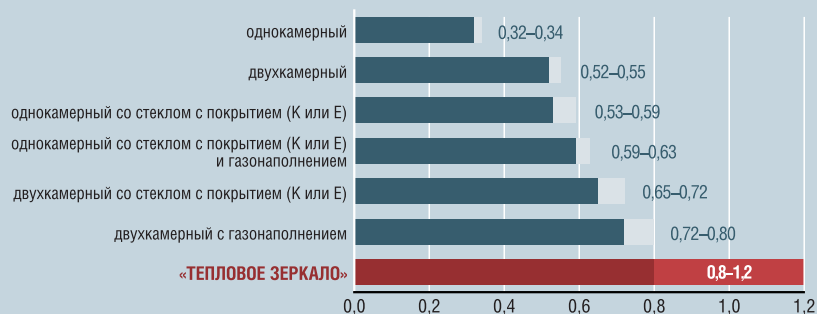
Диаграмма сравнительных характеристик сопротивления теплопередаче (по сравнению с традиционными стеклопакетами)
