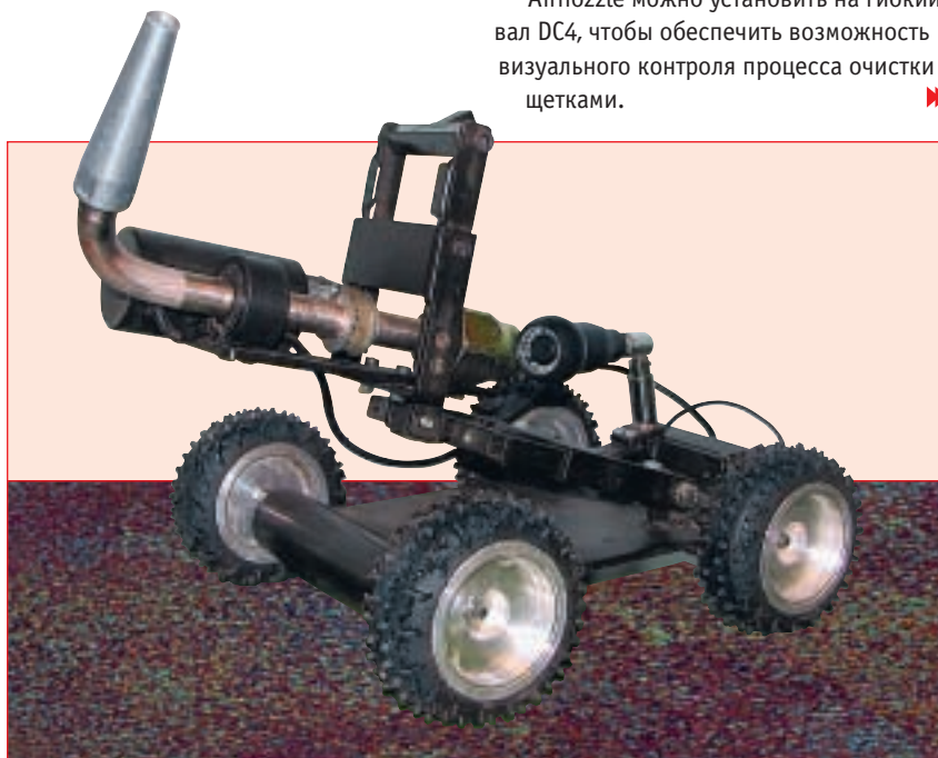
Робот для очистки воздуховодов сухим льдом
