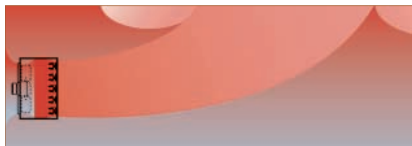
Рис. 1. Стандартные тепловентиляторы: Из-за более высокой температуры выходящего воздуха горячий воздух будет подниматься слишком быстро, следовательно, более холодный воздух будет вытесняться вниз.
