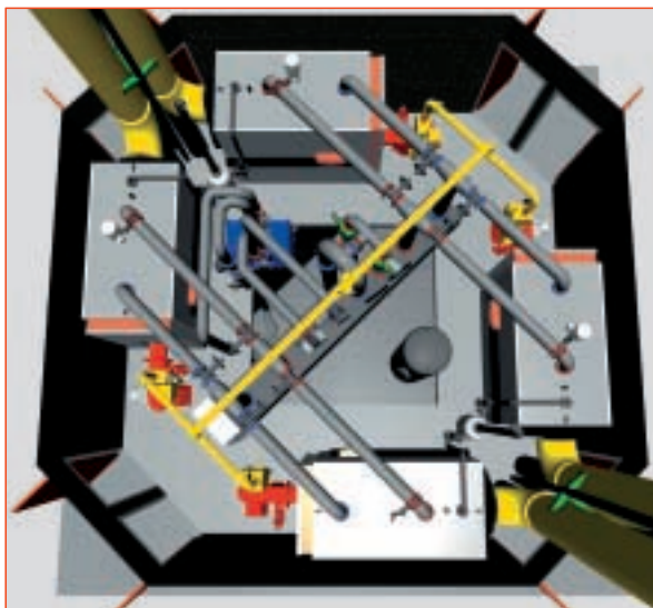
Пример нетрадиционной компоновки котельной: 4 транспортабельных модуля с котлами Vitorplex 100, 1750 кВт, в сумме 7 МВт на площадке 9×9 м.
