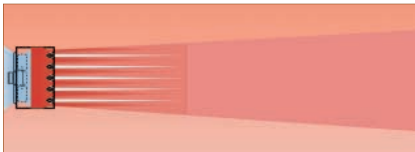
Рис. 2. Решение компании JAGA: система Air-Venturi® Благодаря системе Air-Venturi температура выходящего воздуха понижается, что значительно снижает мощность подъема воздуха. В результате выравнивается температура, ускоряется нагрев и повышается эффективность работы тепловентилятора.
