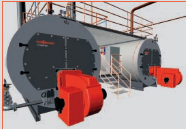
Вид котельной со стороны переднего фронта паровых котлов. Запроектирована «двухэтажная» площадка обслуживания.
