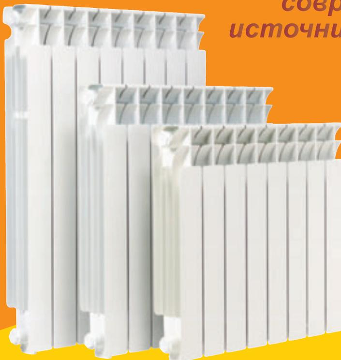
Современные мощные радиаторы **CLAN N** изготавливаются из специального алюминиевого сплава по технологии литье под давлением. Окрашены методом распыления эпоксидной краской с последующей ее полимеризацией при температуре 200°C. Низкая тепловая инерция радиаторов обеспечивает более быстрое достижение рабочей температуры и адекватную работу с терморегулирующими устройствами.
