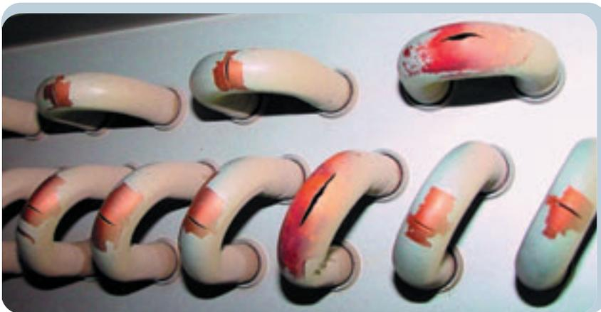
Рис. 3. Разрушение участков трубок («калачей») давлением воды, вытесненной льдом
