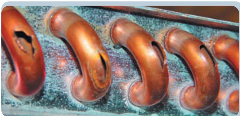
Рис. 1. Разрушение участков трубок («калачей») давлением воды свыше 150 атм
