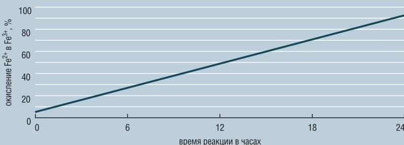
**Рис. 2. Окисление Fe<sup>2+</sup> озоном** (температура 22°C, pH = 5,9)
