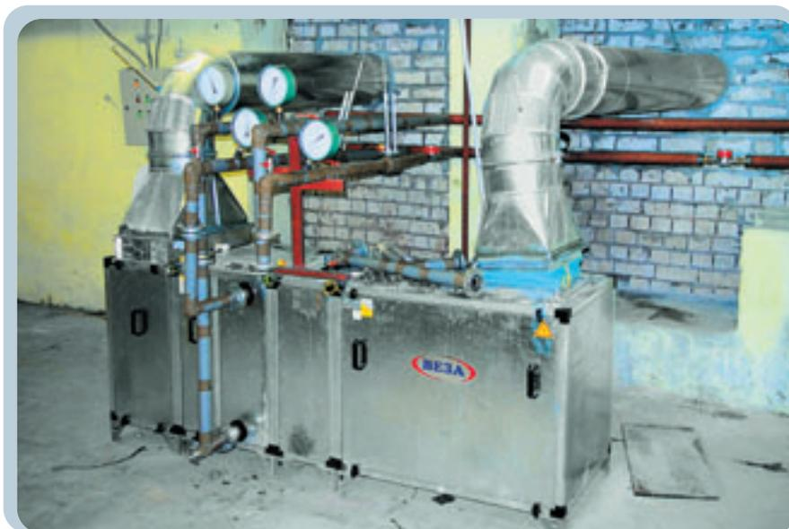
Испытательный стенд компании «Веза» для теплообменника НТО-243
