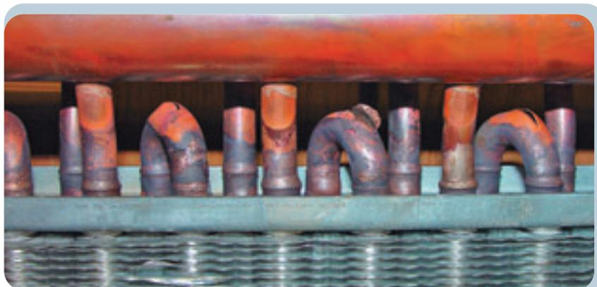
Рис. 4. Разрушение участков трубок («калачей») давлением воды, вытесненной льдом
