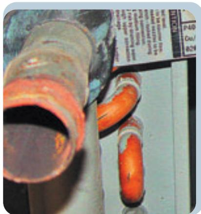
Рис. 5. Отшелушивание краски при разрывах участков трубок («калачей»)
