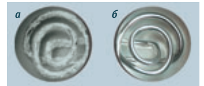
Рис. 3 Поверхности нагревательных элементов двух электрочайников после недели эксплуатации на жесткой воде водопровода (г. Гатчина Ленинградской обл., вода кипятится 4 раза в день, а — использовалась вода без дополнительной обработки; б — вода прошла обработку ФП)
