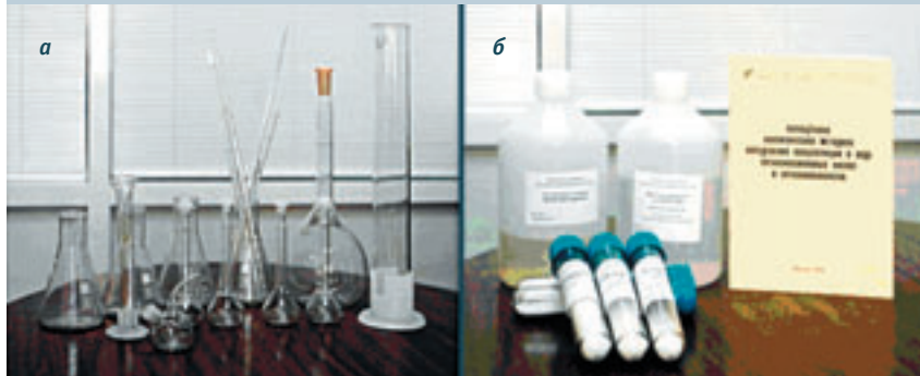
Рис. 3. Наборы химической посуды (а) и химических реактивов (б), выпускаемые ООО НПЦ «ХИТ» для контроля концентрации фосфонатов по упрощенной методике
