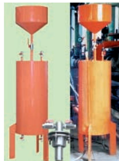
Рис. 4. Устройство дозирования ингибиторов «Иж-25»: а — внешний вид; б — монтаж в паровой котельной птицефабрики «Вараксино» (Удмуртия)
