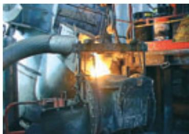
Рис. 2. Современные индукционные печи емкостью 38 тонн
