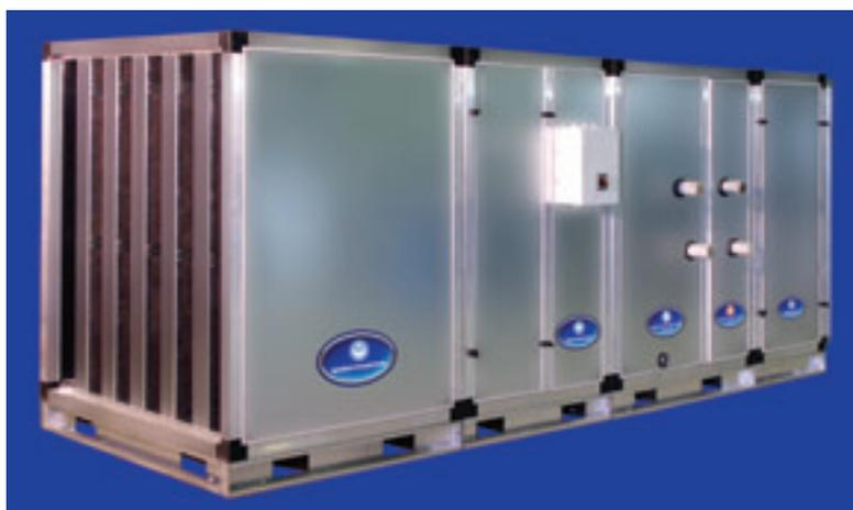
Центральные кондиционеры изготавливаются в пяти типоразмерах с производительностью по воздуху от 3000 м<sup>3</sup>/ч до 40000 м<sup>3</sup>/ч, и представляют собой набор последовательно размещенных функциональных блоков (секций).
