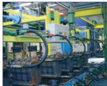
Рис. 12 Гидравлические испытания на герметичность уже собранных теплообменников давлением в 1,5 раза превышающим максимальное рабочее
