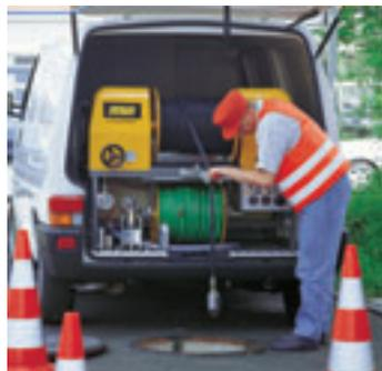
при установке на прицеп; ограничение числа оборотов препятствует переработке насоса; превышение мощности предотвращается благодаря большому запасу прочности мотора и насоса; долговечность мотора, насоса и гидравлики благодаря высококачественной конструкции; минимальный уход; специальная подготовка к российскому климату; функцио-
