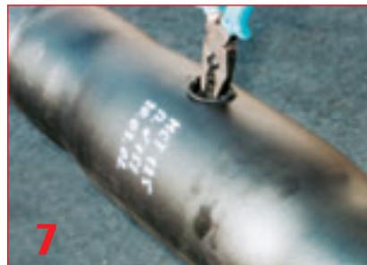
7. После затвердения пены дренажная пробка удаляется и заливочное отверстие заваривается полиэтиленовой пробкой.
