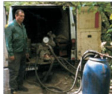
Установка для гидрохимической промывки систем отопления и теплообменного оборудования
