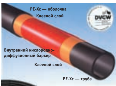
Рис. 1 Структура трубы Pexfit PLUS
