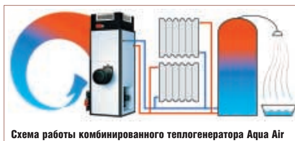
Теплогенератор на отработанном масле
