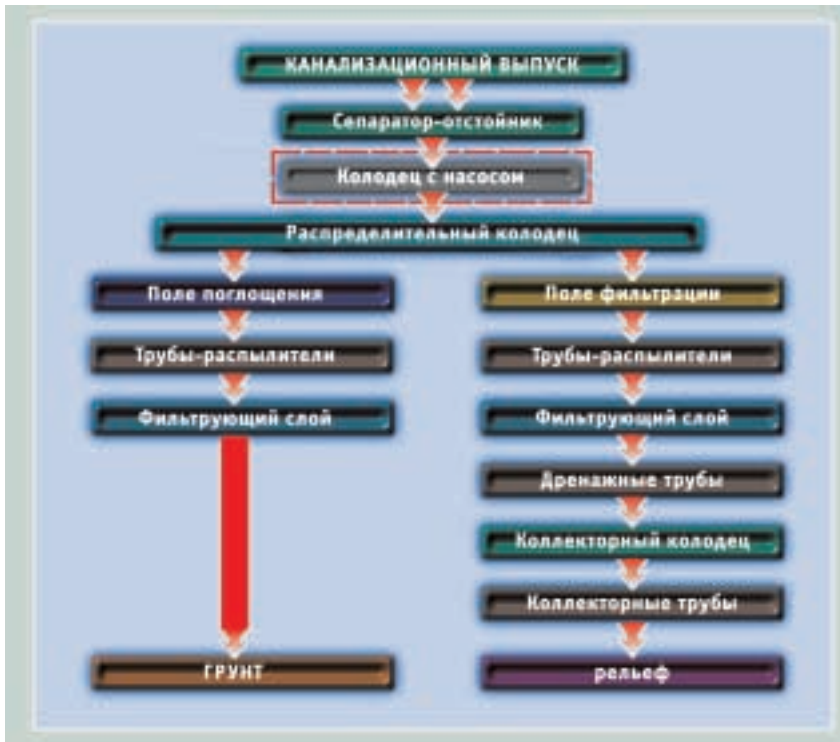
Рис. 1. Принцип работы локальной системы очистки Uponor Sako
