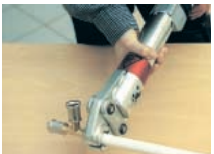
Соединения с запрессовывающимся кольцом для труб PE-Xc/Al/PE-Xc
