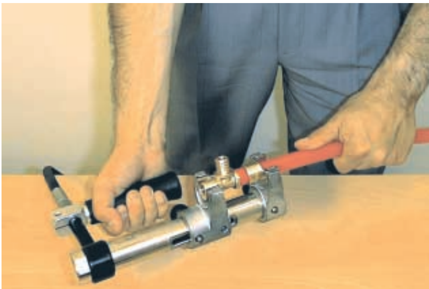
Для выполнения соединений со сплошным кольцом применяется гидравлический пресс
