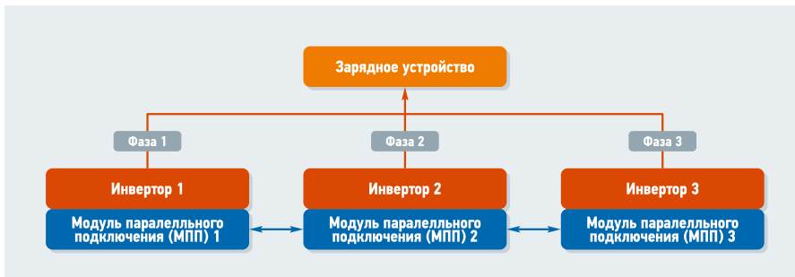
Рис. 1. Схема параллельного подключения инверторов
