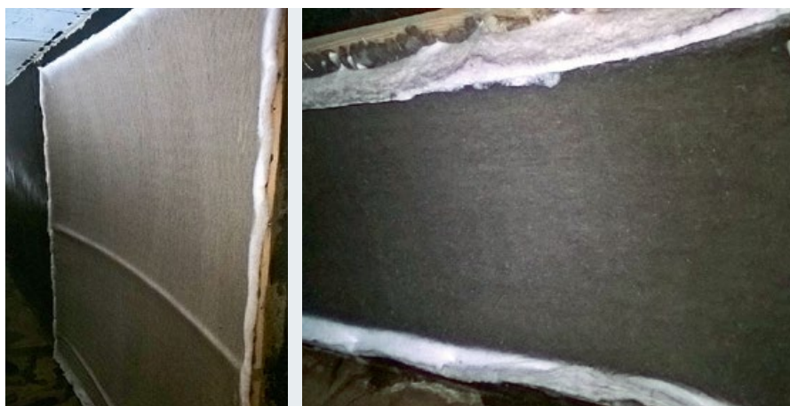
■ Рис. 5. Синтепон после семи (слева) и 14 дней эксплуатации системы
